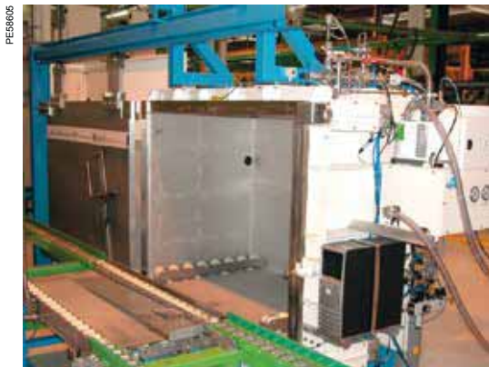
SF6 leak test
